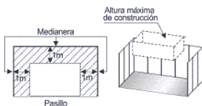
Stand entre 3 medianeras El rayado /// indica donde la altura máxima de construcción es 2,5 m.
